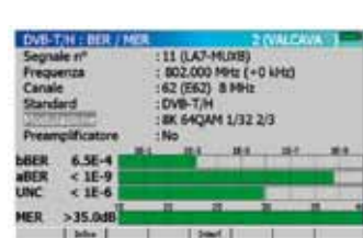
Frequenza di lavoro da 45 a 2150 MHz Elevata sensibilità per misure in DVB-T della potenza, del BER e del MER a partire da 35dBµV.
