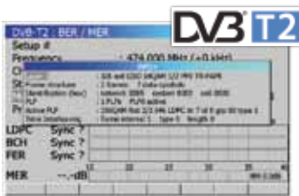
Visualizzazione delle seguenti misure: LDPC: tasso di errore pre LDPC BCH: tasso di errore post LDPC FER: tasso di errore sulle trame, tasso di errore post LDPC (pacchetti persi) MER: tasso di errore per modulazione
