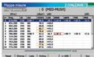
TOTALMAP - mappa delle misure che visualizza e registra tutte le misure (fino a 100) in una schermata riassuntiva con verifica immediata delle misure confrontate con i livelli di soglia (min-max) pre-impostati.
